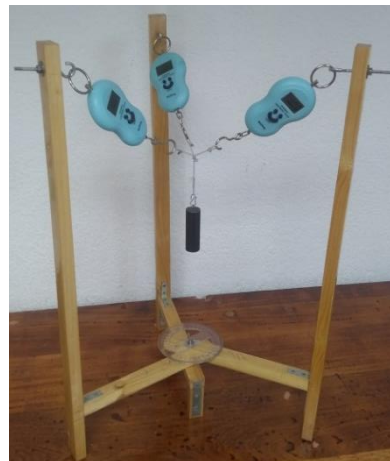
Fig. (2) Sistema de cuatro fuerzas elaborado por ingenieros del laboratorio de física.
